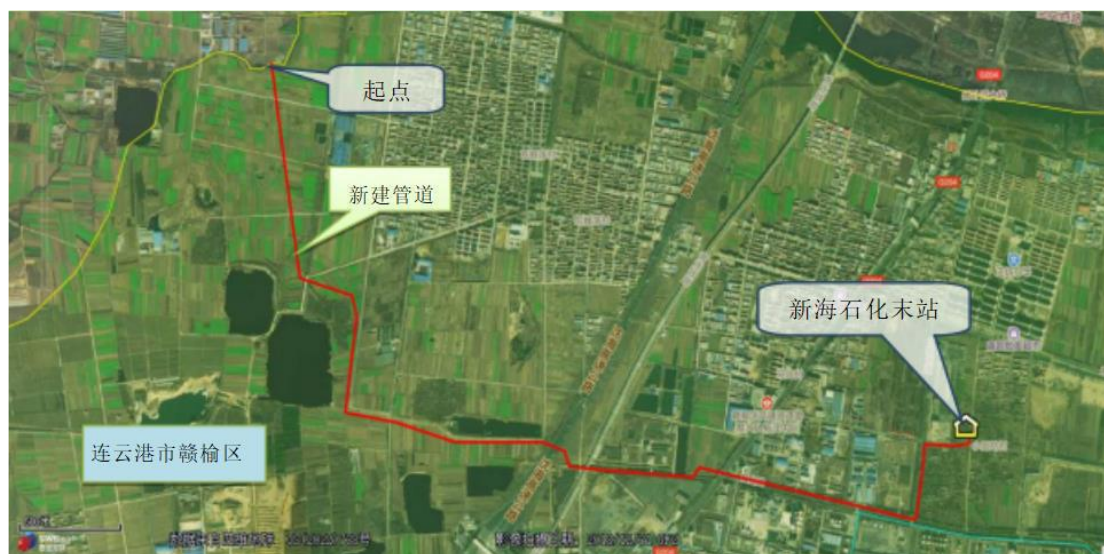
图 1.1-2 原油输送管道（管道工程）平面布置图
