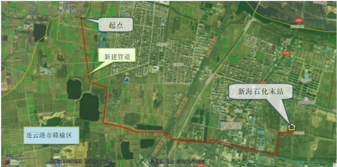
图1.1-2 原油输送管道（管道工程）平面布置图
