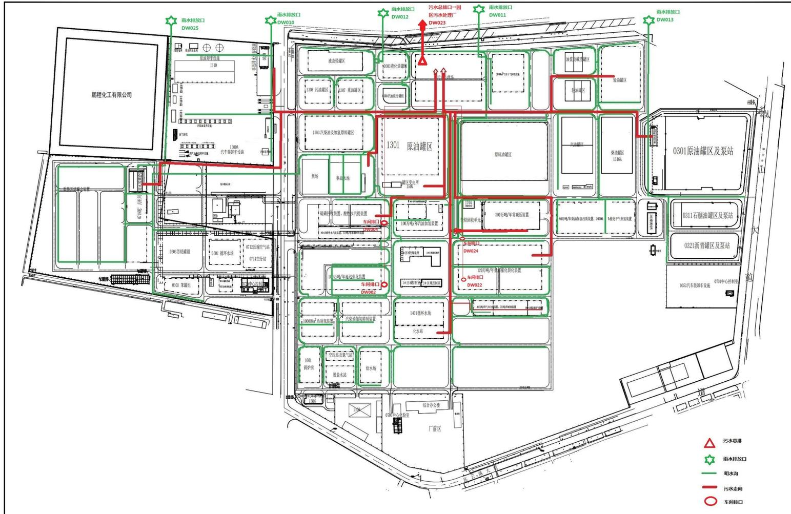
图 2.3-2 企业雨水、污水水管线布置图
